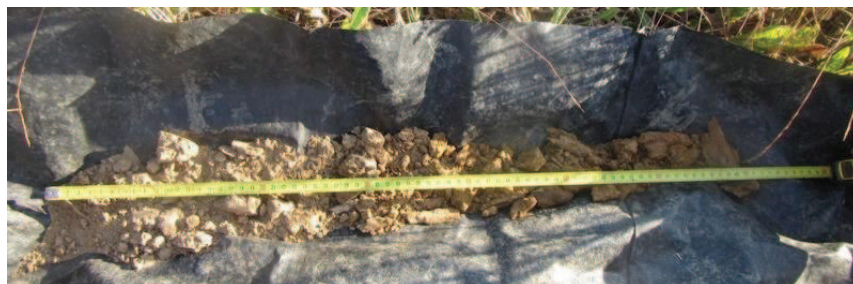
Sondage S07, Limon sableux à argile limono sableuse en profondeur, quelques traits rédoxiques
